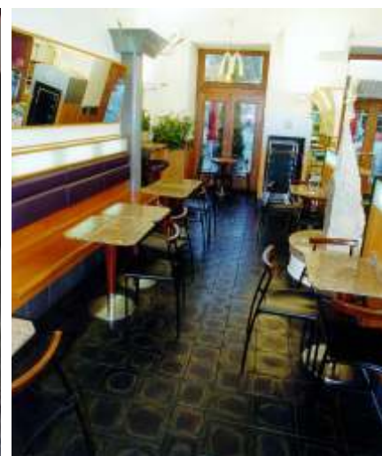
DLAŽBA Z TAVENÉHO ČEDIČE ROZMĚR 200x200 nebo 250X250 mm VZNIKÁ TAVENÍM PŘI TEPLOTĚ OKOLO 1300°C
