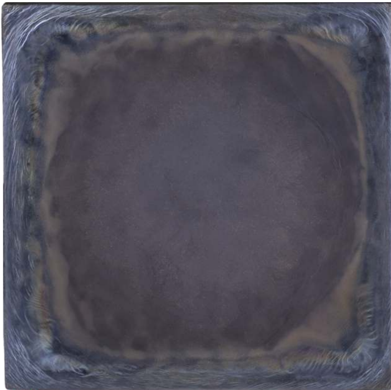
DLAŽBA Z TAVENÉHO ČEDIČE ROZMĚR 200x200 nebo 250X250 mm VZNIKÁ TAVENÍM PŘI TEPLOTĚ OKOLO 1300°C
