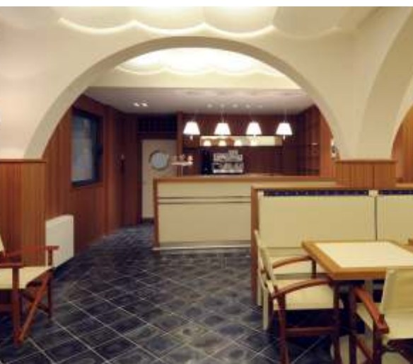
DLAŽBA Z TAVENÉHO ČEDIČE ROZMĚR 200x200 nebo 250X250 mm VZNIKÁ TAVENÍM PŘI TEPLOTĚ OKOLO 1300°C
